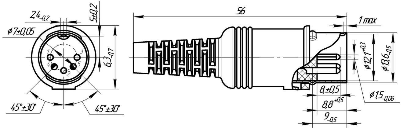
Примечание: В трёхконтактной вилке в отверстия  $\bullet$  контакты не закладываются.
