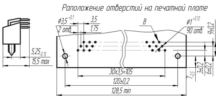
Предельные отклонения размеров между осями двух любых отверстий  $B \pm 0,2$  мм
