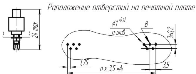
Предельные отклонения размеров между осями двух любых отверстий  $B \pm 0,2$  мм
