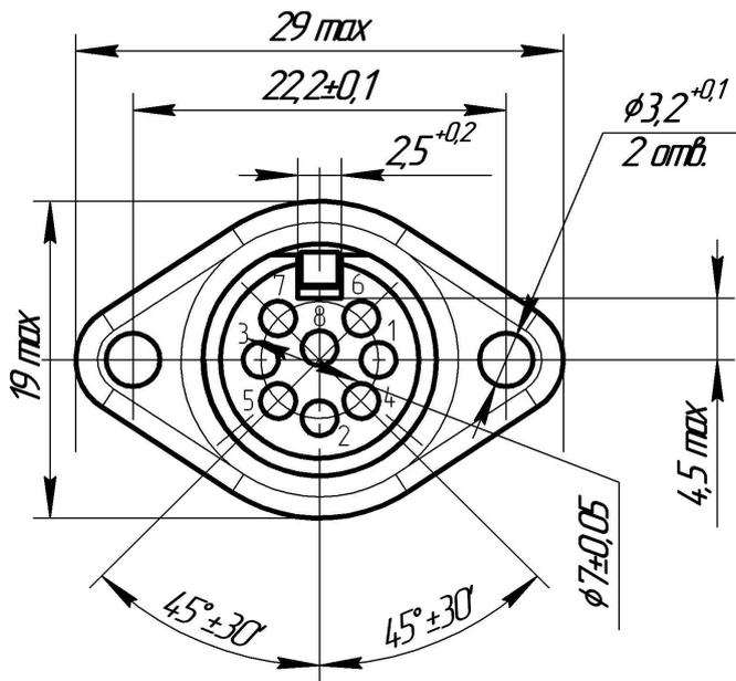
Примечание. В трехконтактной, пятиконтактной и семиконтактной розетке в отверстия контакты не закладываются.
