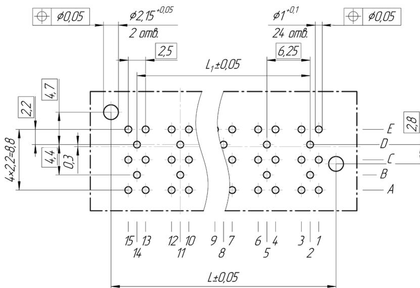
Разметка для крепления розеток приборных CP-50-990-МКП-2-Р, CP-50-990-МКП-4-Р, CP-50-990-МКП-6-Р, CP-50-990-МКП-8-Р, CP-50-990-МКП-10-Р на печатную плату.
