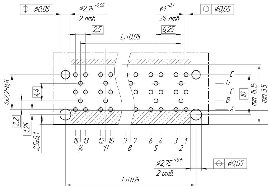
Разметка для крепления вилок приборных CP-50-989-МКП-2-В, CP-50-989-МКП-4-В, CP-50-989-МКП-6-В, CP-50-989-МКП-8-В, CP-50-989-МКП-10-В на печатную плату.
